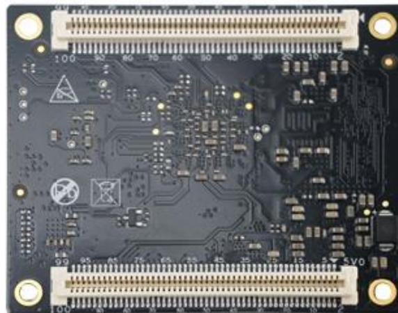
*MYC-C8MMX-V2 CPU Module Bottom-View*
